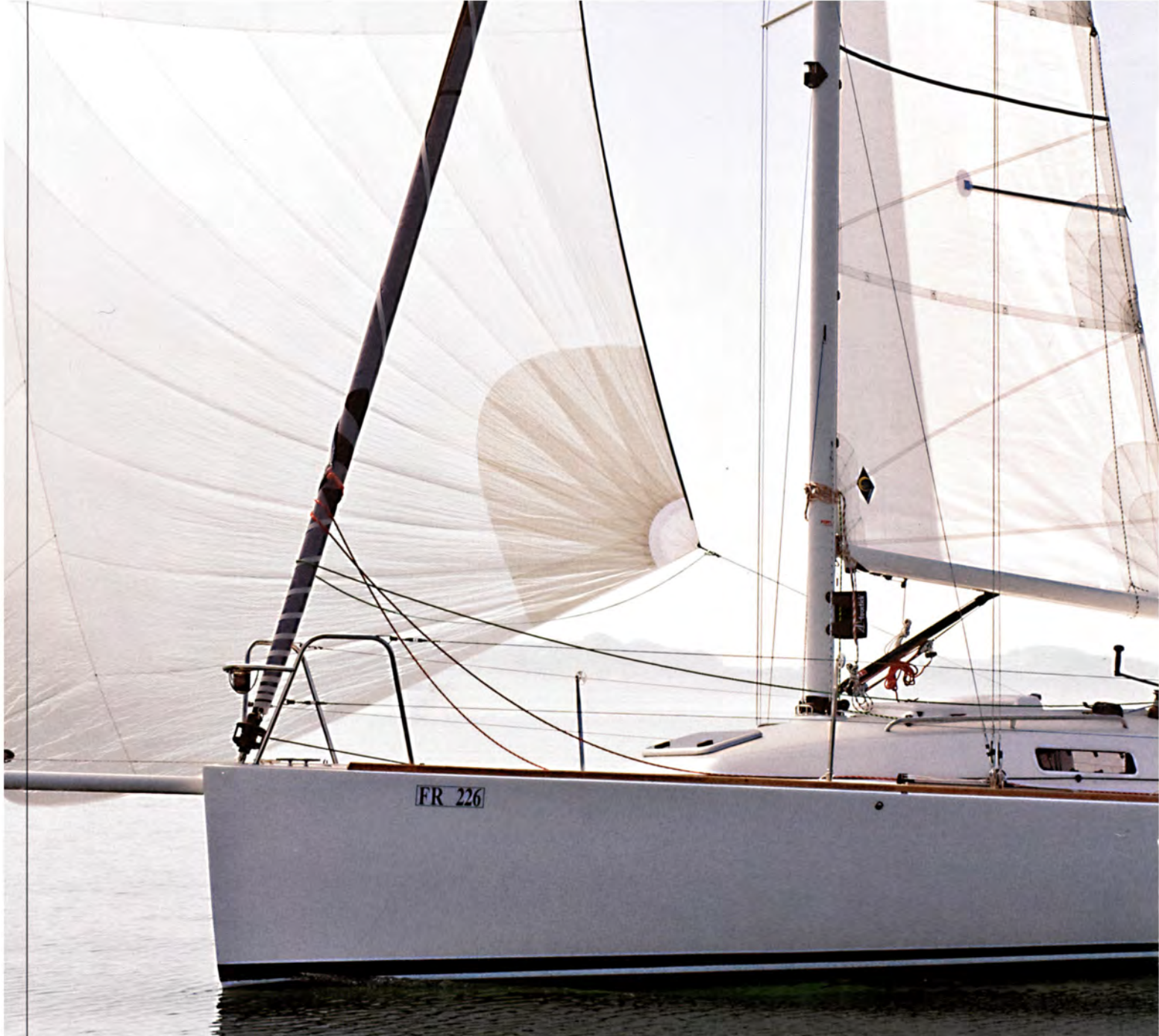
Die J 95 ist nur drei Meter breit und hat minimal einen Tiefgang von 0,91 Metern.
